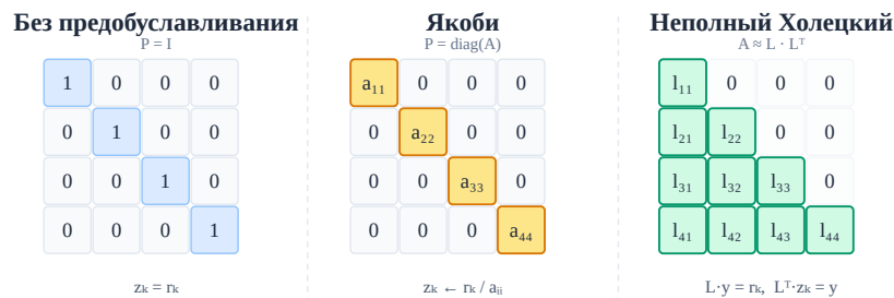
Рис. 3.3. Предобуславливатели: единичный ( P = I ), Якоби ( P = \text{diag}(A) ) и неполный Холецкий ( A \approx L \cdot L^T ).
